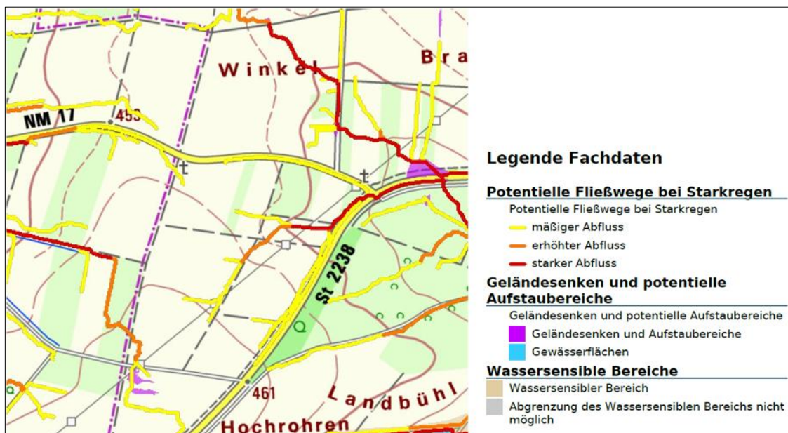
Abb.: Ausschnitt Hinweiskarte Oberflächenabfluss und Sturzflut mit Legende (veröffentlicht am 23.01.2024) Herausgeber: Bayerisches Landesamt für Umwelt (LfU)
